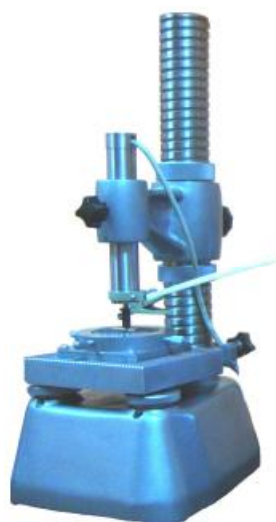
а) Оптиметр электронный вертикальный ИКВэ
