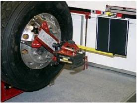
Общий вид устройств для измерений углов установки колес и положения осей грузовых автотранспортных средств Truckaligner II, Truckaligner II PC, Truckaligner 180, I-Track, Speedaligner, Speedfactory
