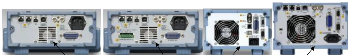
Рисунок 2 – Схема пломбировки от несанкционированного доступа.
