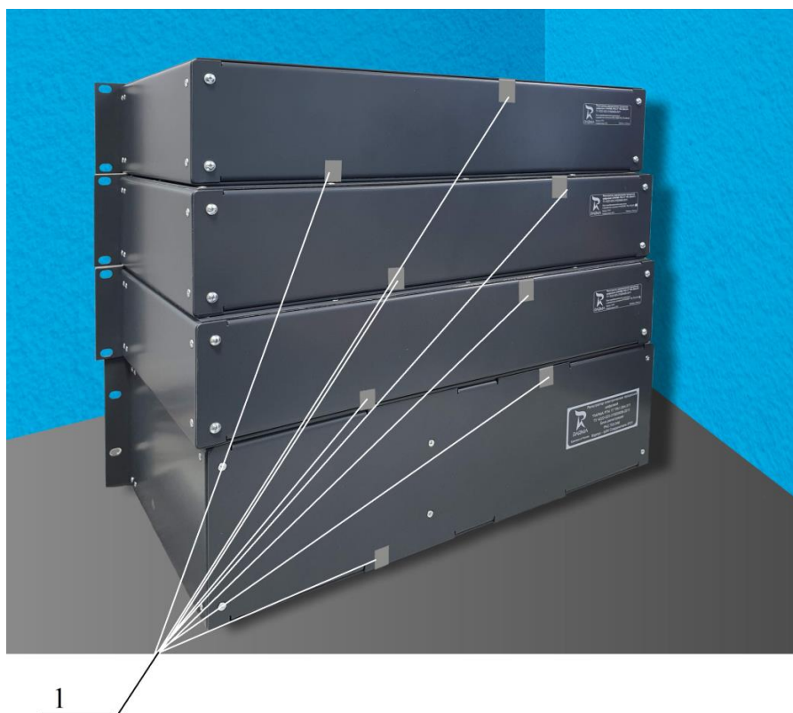
Рисунок 3 – Схема пломбировки от несанкционированного доступа регистратора «Исполнение 2»
