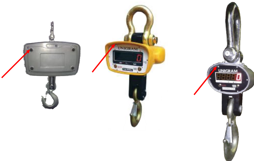
Рисунок 3 Схема пломбировки от несанкционированного доступа и обозначение места для нанесения отиска клейма.
