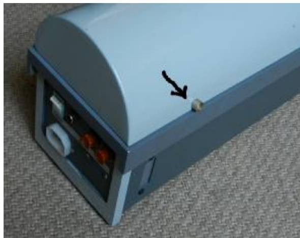
Рисунок 2 - Схема пломбирования крышки установок
