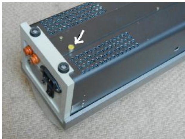
Рисунок 3 - Схема пломбирования кожуха установок
