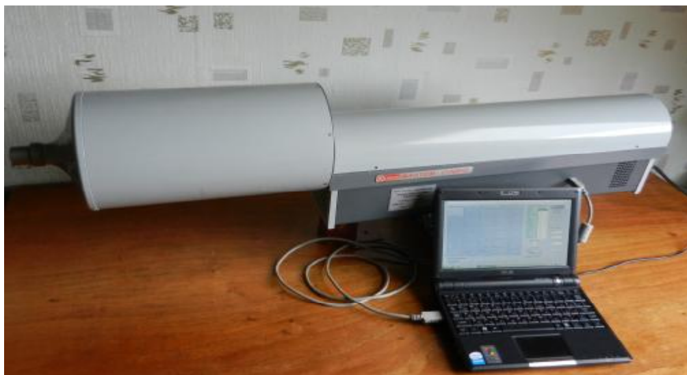
Рисунок 1 - Общий вид установки поверочной «ГВП Фантом-Спиро»
