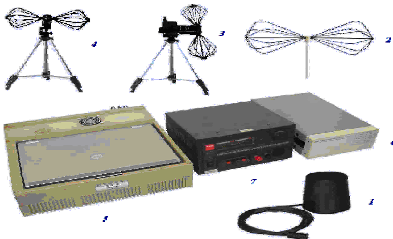
Рисунок 1 – Внешний вид элементов станции: 1 – антенна А111С; 2 – антенна П6-45; 3 – антенна П6-51; 4 – антенна П6-52; 5 – устройство БОС-12; 6 – стандарт частоты FS725; 7 – блок питания GSV 3000
