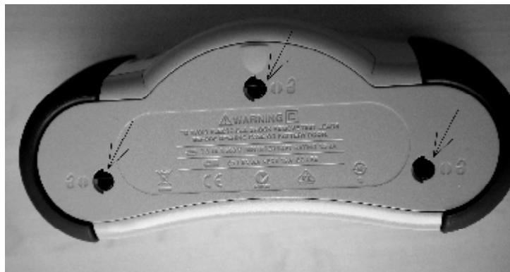
Рисунок 2 – Пломбы для защиты от несанкционированного доступа на задней поверхности тестера
