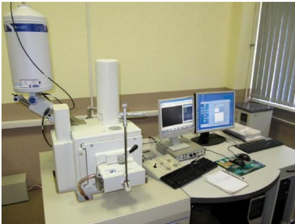
Рисунок 1 – Общий вид микроскопа электронного сканирующего JSM-6490LV
