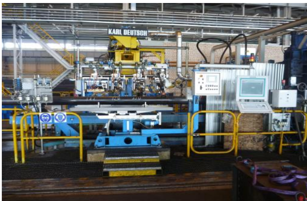
Рисунок 1 – Внешний вид системы контроля сварного шва ультразвуковой Karl Deutsch SNHF Echograph 1155 4L/2Q
