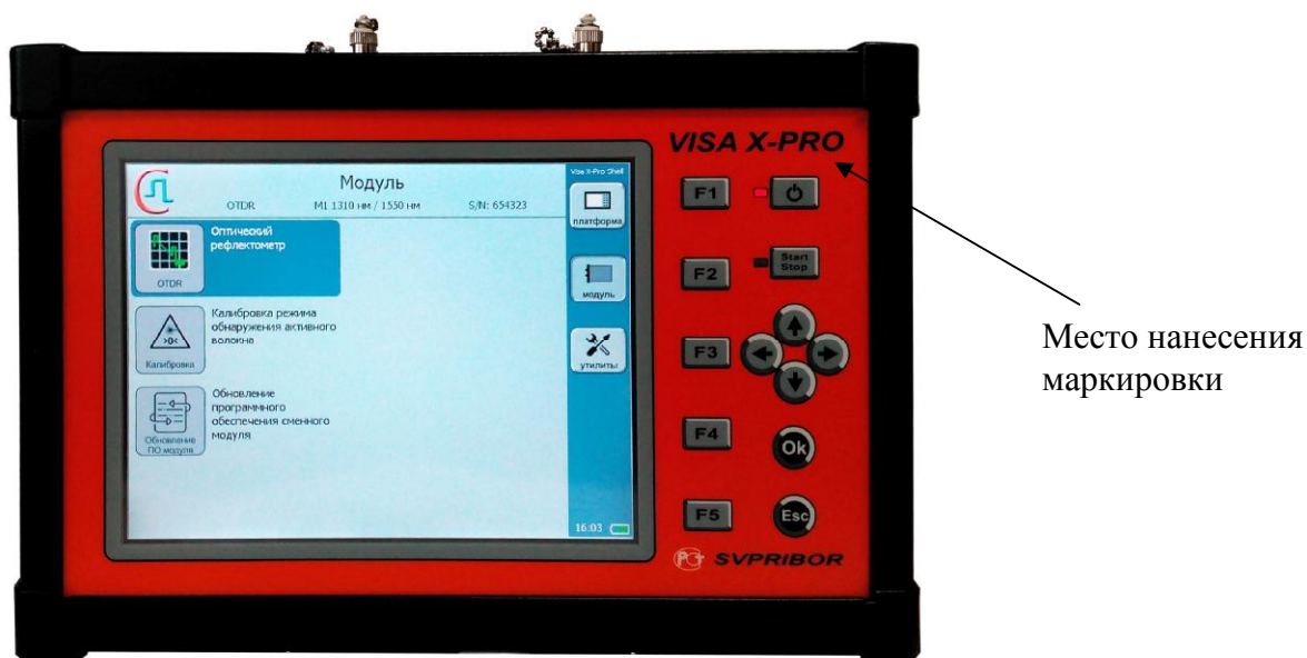
Рисунок 2 - Передняя панель управляющего модуля с обозначением места нанесения маркировки
