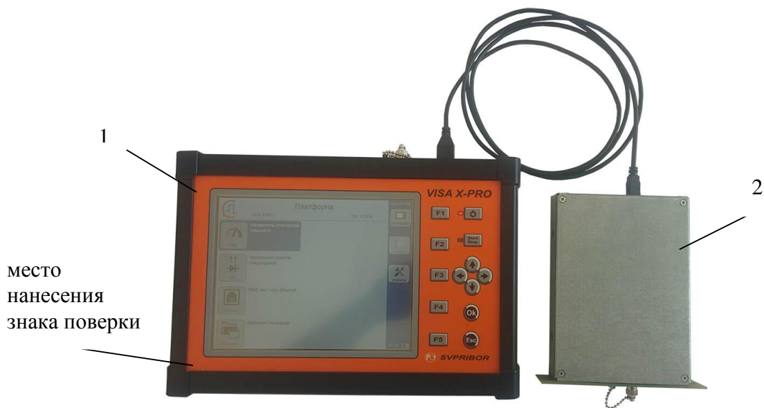
Рисунок 1 - Общий вид рефлектометра с обозначением места нанесения знака поверки 1 - управляющий модуль X-PRO; 2 - измерительный модуль VISA USB;
