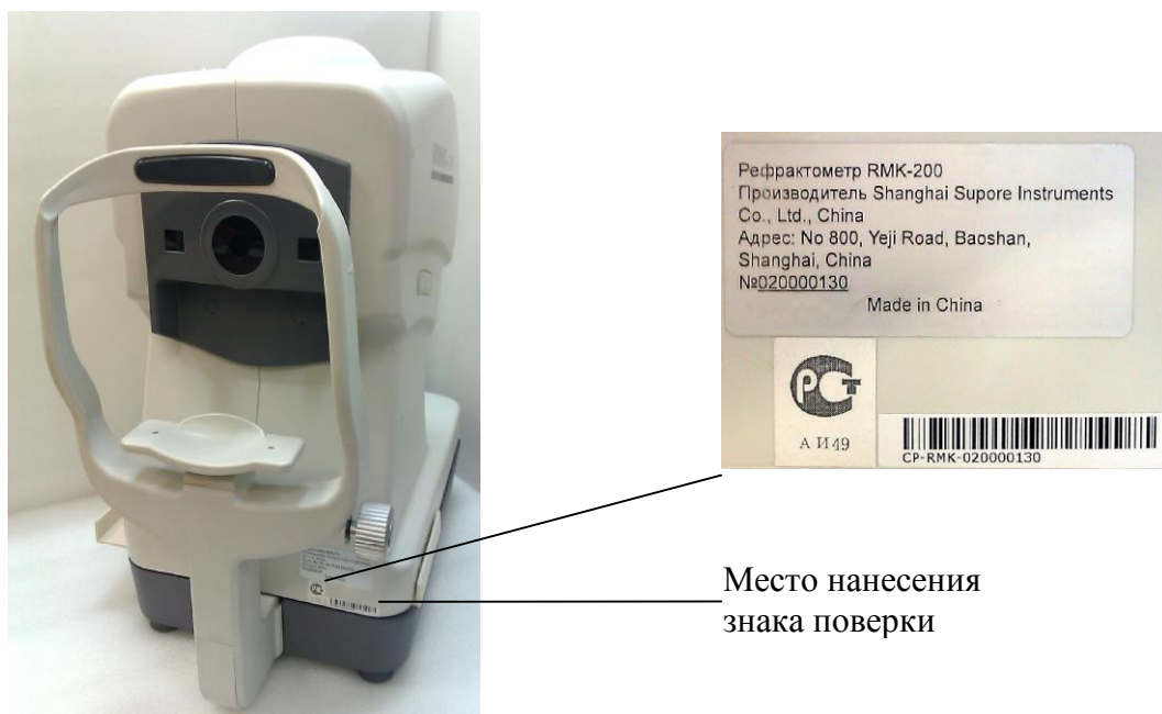
Рисунок 2 - Вид сзади и схема маркировки рефрактометра RMK-200
