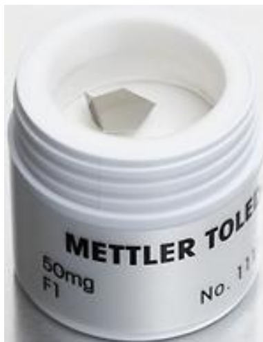
Рисунок 3 – Общий вид гирь в форме многоугольной пластины
