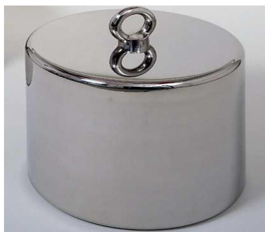
Рисунок 7 – Общий вид гирь из нержавеющей стали в форме цилиндра с кольцом для захвата
