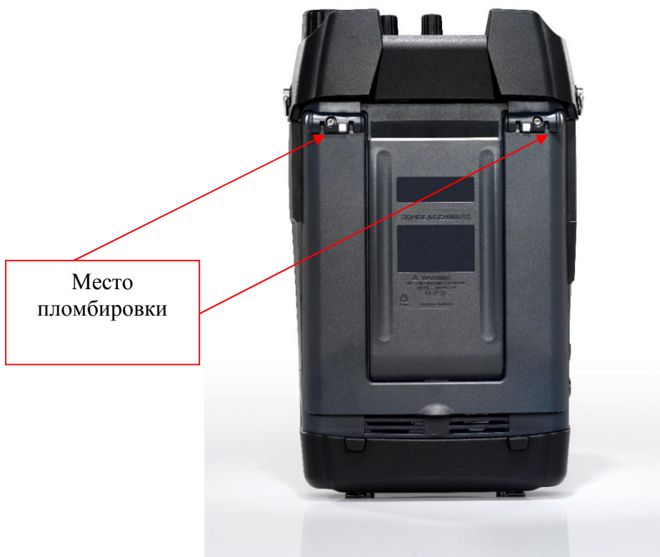
Рисунок 2 - Схема пломбировки от несанкционированного доступа
