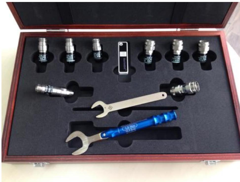
Рисунок 1 – Внешний вид набора мер коэффициентов передачи и отражения ZV-Z270
