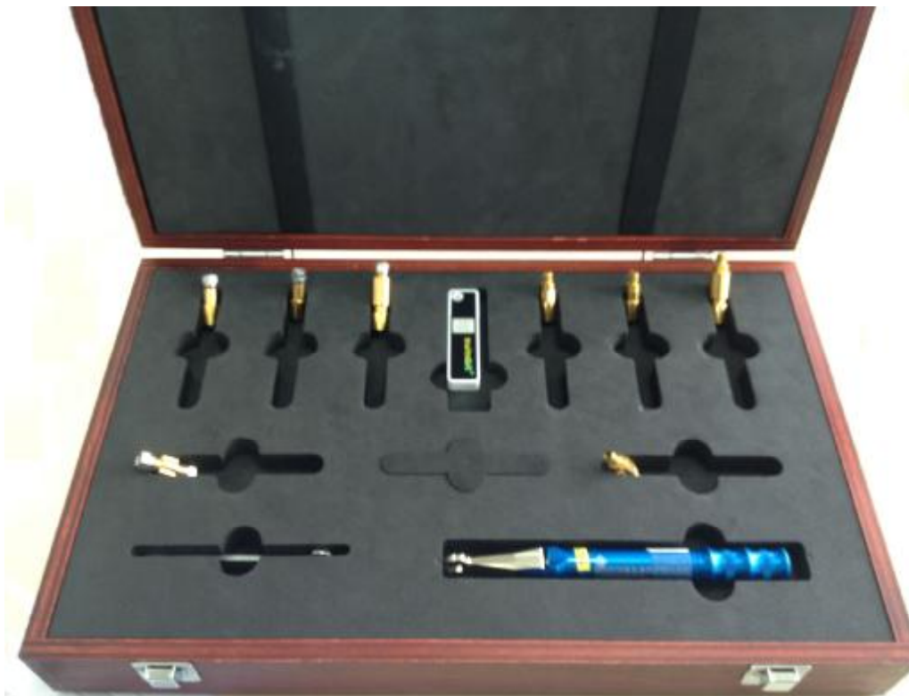
Рисунок 2 – Внешний вид набора мер коэффициентов передачи и отражения ZV-Z235 и ZV-Z224
