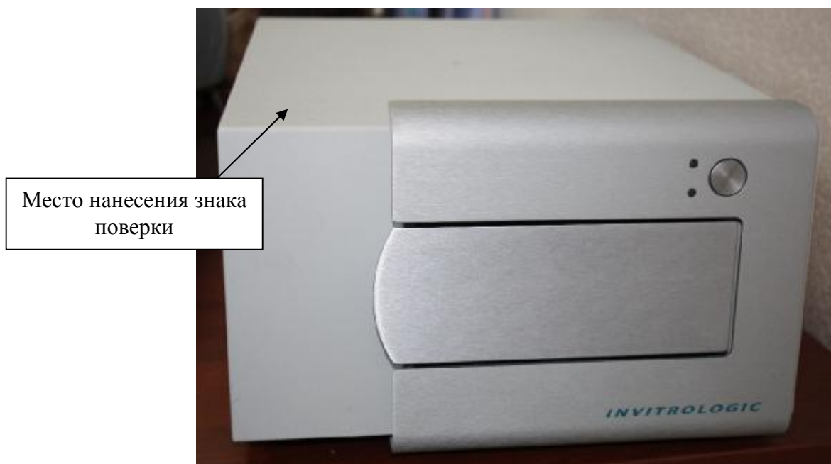
Рисунок 1 - Общий вид фотометров для микропланшет «InVtroLogic» с обозначением места нанесения знака поверки
