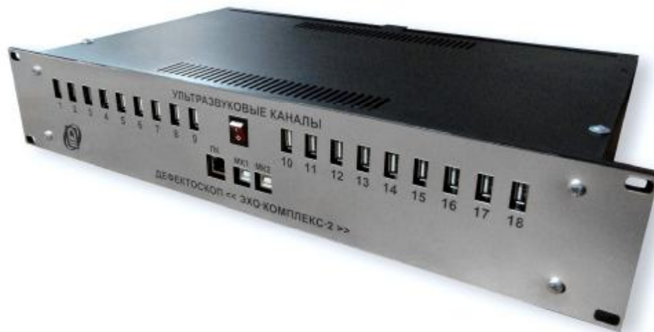
Рисунок 1 – Общий вид блока электронного дефектоскопа
