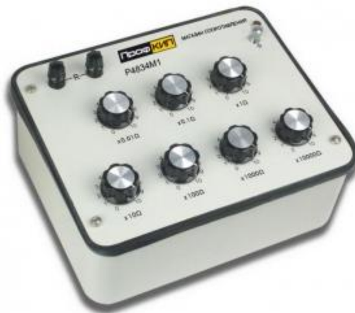
Рисунок 1 – Общий вид магазина сопротивлений
