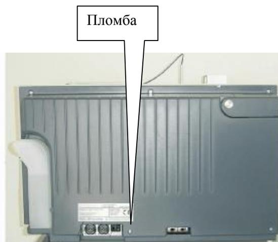
Рисунок 2 – Анализатор для исследования гемостаза серии Helena модели АС-4. Расположение пломбы.
