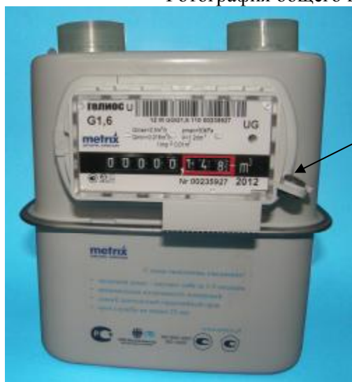
Фотография общего вида счетчика с указанием места пломбирования
