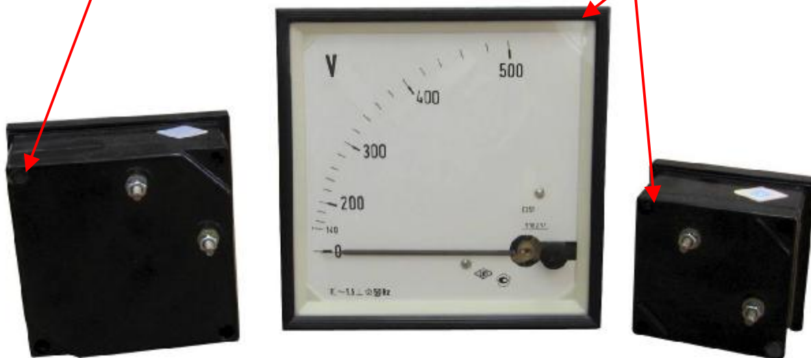
Рисунок 2. Места нанесения поверительного клейма.
