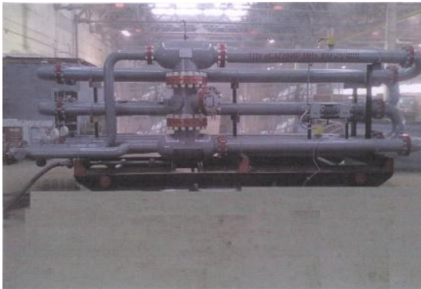
Рисунок 1 - Общий вид установки трубопоршневой «Сапфир МН»-300-2,5-0,09
