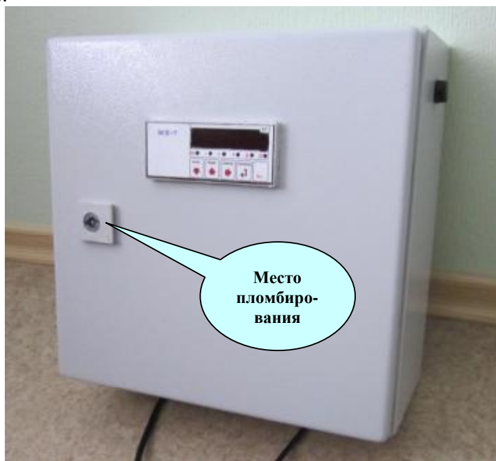
Рисунок 2 Внешний вид индикатора ВСП-7 в приборном шкафу ТНМ-55-30.30.15 и схема пломбировки от несанкционированного доступа, и обозначение места для нанесения оттиска клейма
