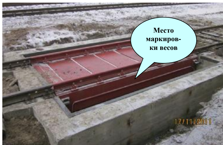
Рисунок 3 Общий вид весов вагонных ВЭД
