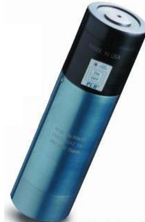
Рисунок 1 - Виброустановка калибровочная портативная модели 394C06
