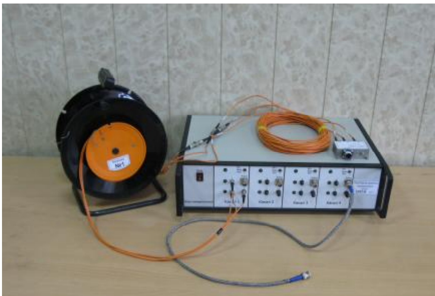
Рисунок 4 – Общий вид преобразователя наведенных токов многоканального измерительного ПНТ-8 (в сборе)
