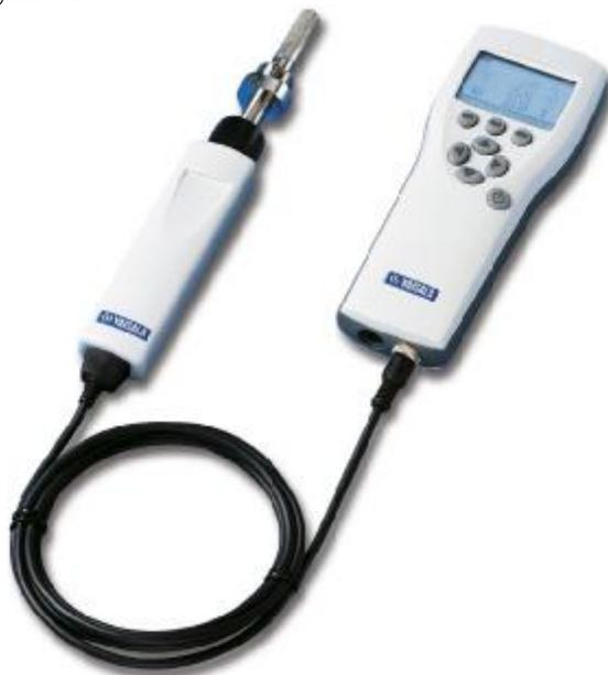
Рисунок 1. Внешний вид термогигрометра DM70
