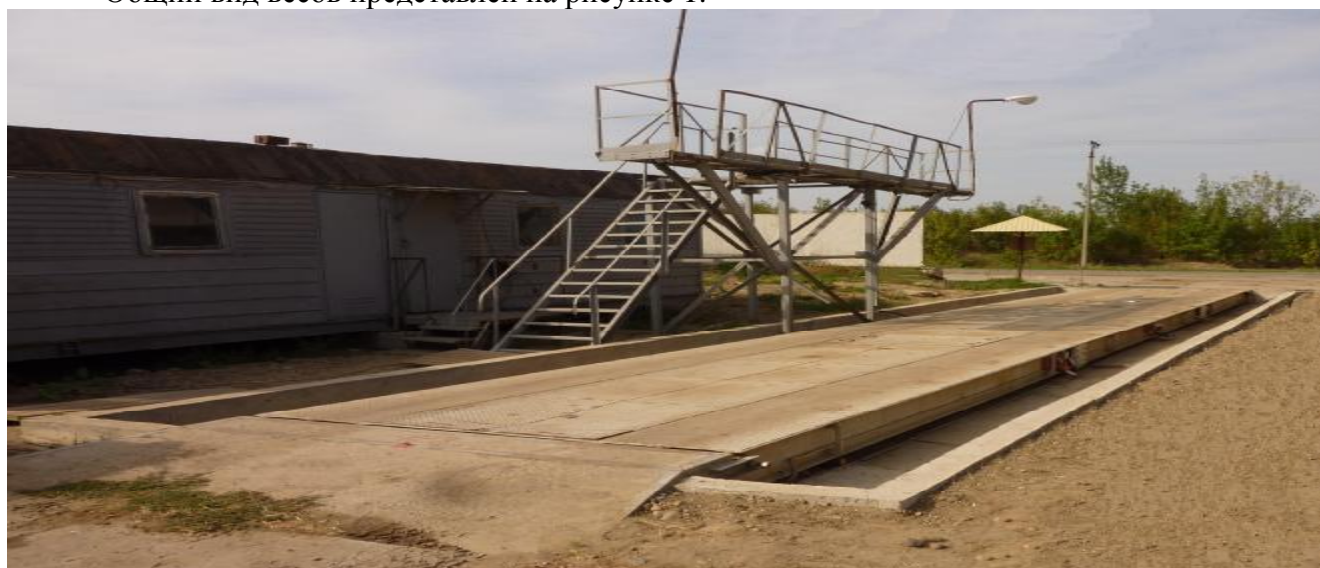
Рис. 1. Общий вид весов ВКА
