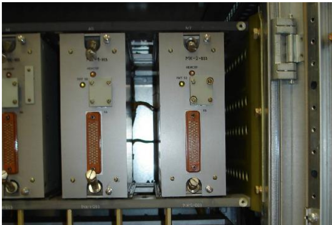
Рисунок 3 — Размещение модуля МК-2-003 в приборах КМТ А1(2)СLА01ЕG011...ЕG016
