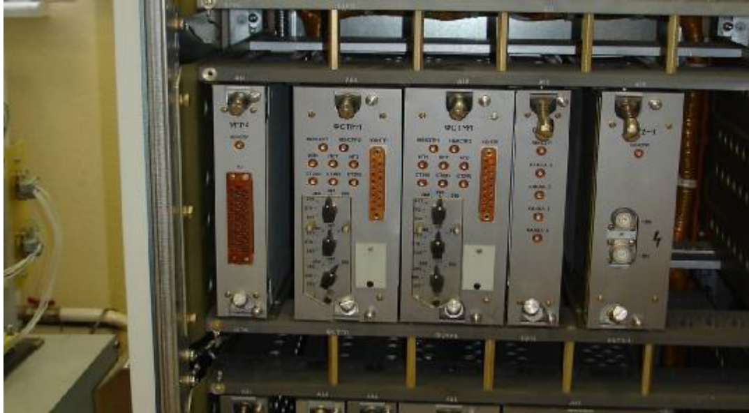
Рисунок 2 — Размещение модулей ФСТМ1 и УГР4 в приборах КМТ А1(2)СLА01ЕG011...ЕG016
