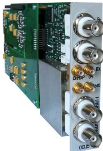
Рисунок 4 – Внешний вид осциллографа цифрового ОСЦ5 UNC3.031.150
