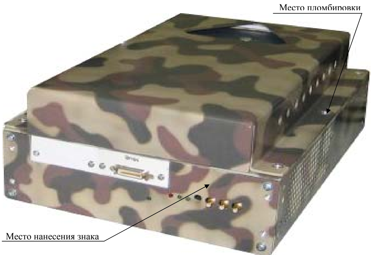
Рисунок 2 – Внешний вид устройства MezaBox\Battery 133W-hrs с установленным электронным магазином, указанием места нанесения знака утверждения типа и местом пломбировки
