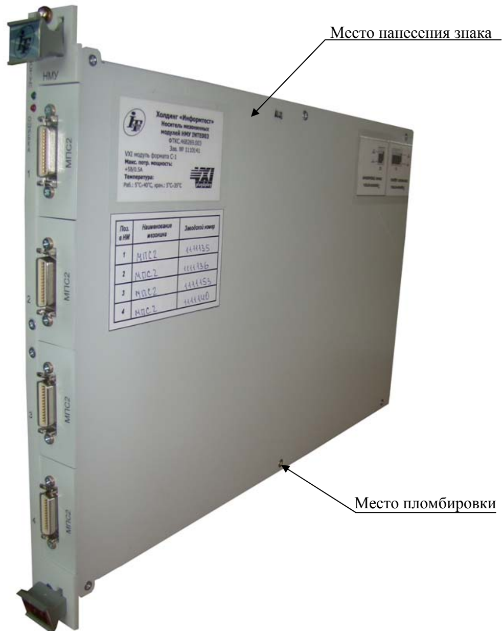
Рисунок 3 – Внешний вид носителя мезонинных модулей типа НМ (НМ-С, НМУ) с установленными электронными магазинами, указанием места нанесения знака утверждения типа и местом пломбировки
