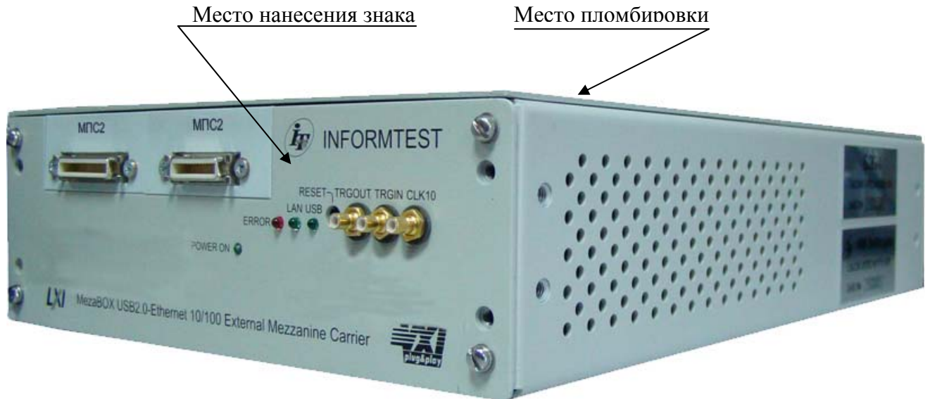
Рисунок 1 – Внешний вид устройства MezaBox с установленными электронными магазинами, указанием места нанесения знака утверждения типа и местом пломбировки
