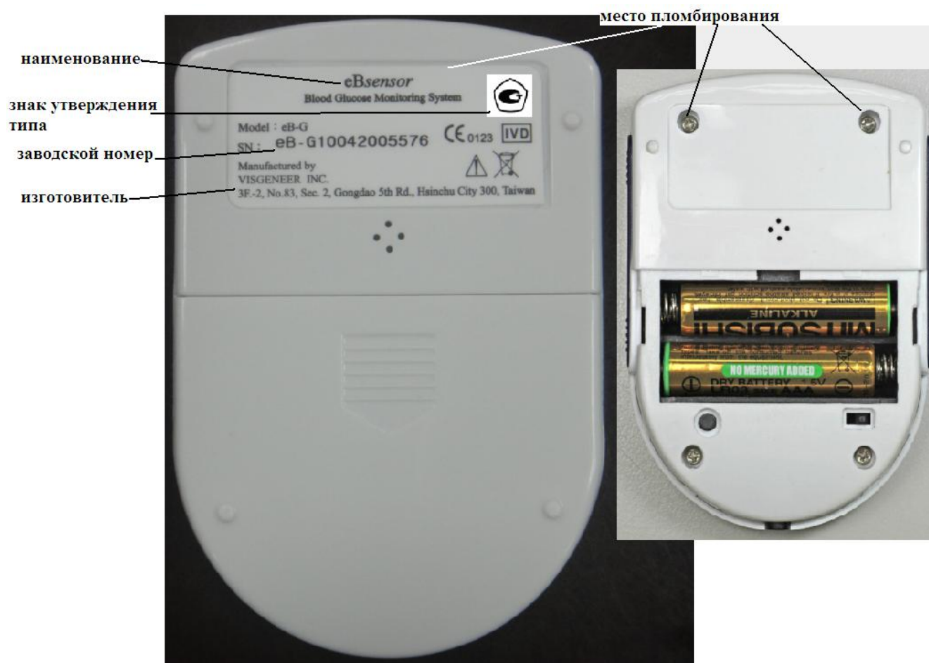
Рисунок 2 – Схема маркировки и пломбировки
