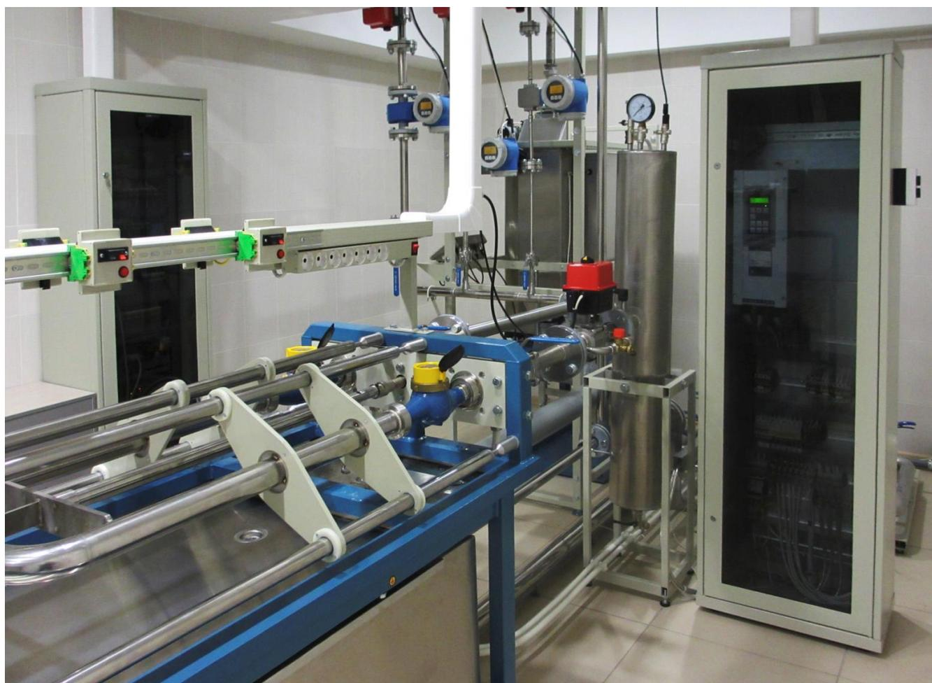
Рисунок 1. Внешний вид установки поверочной проливной FLOWTEST-6
