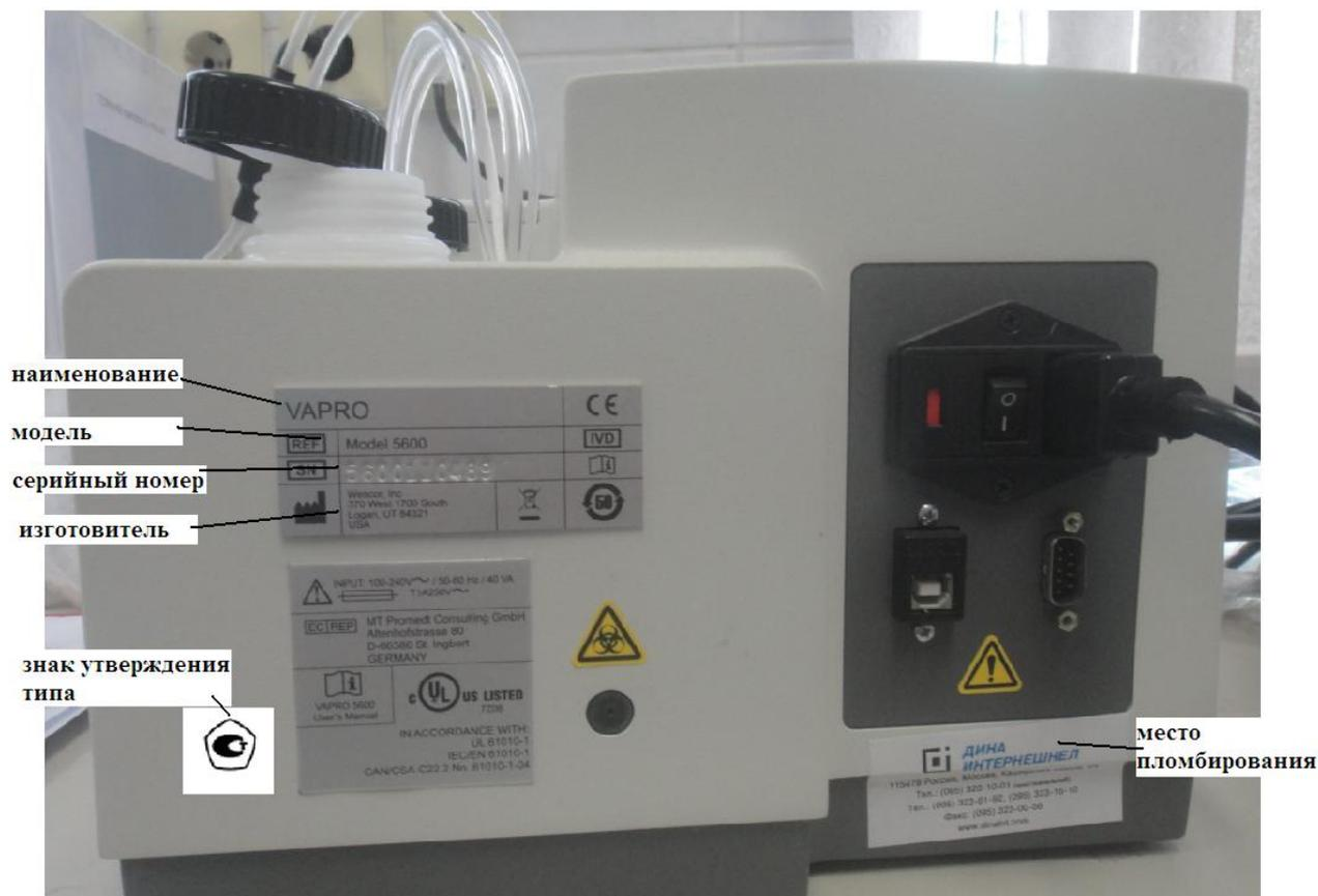
Рисунок 2 – Схема маркировки и пломбирования
