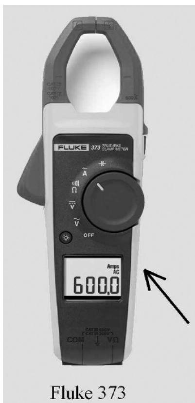
Рисунок 1 - Внешний вид клещей модели Fluke 373, стрелкой показано место нанесения знака утверждения типа.
