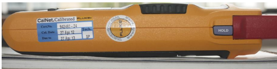
Рисунок 3 - Место пломбирования от несанкционированного доступа
