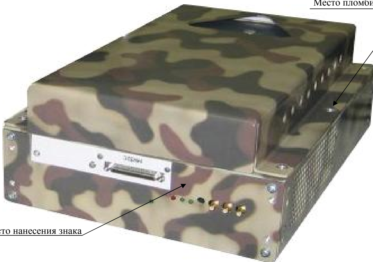
Рисунок 2 – Внешний вид устройства MezaBox Battery 133W-hrs с установленным измерителем, указанием места нанесения знака утверждения типа и местом пломбировки
