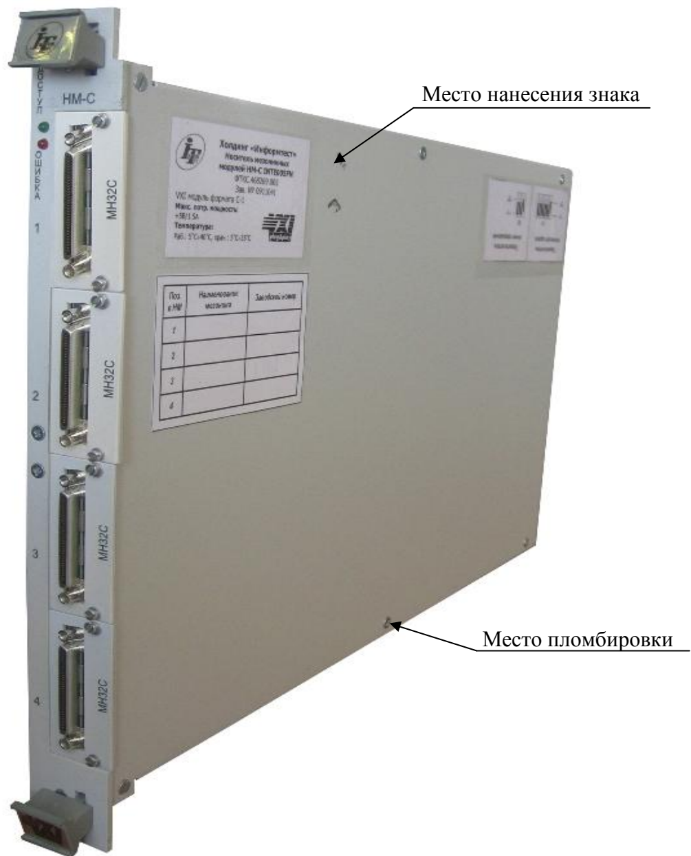
Рисунок 3 – Внешний вид носителя мезонинных модулей типа HM-C (HM, HMY) с установленными измерителями, указанием места нанесения знака утверждения типа и местом пломбировки
