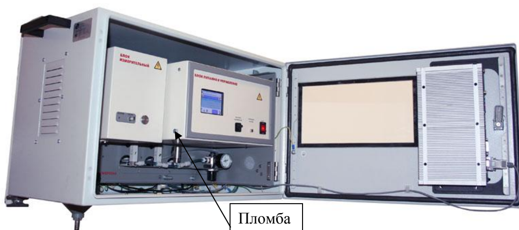
Рисунок 1 - Анализатор спектральный ЭМИС-2 с указанием мест пломбировки от несанкционированного доступа.
