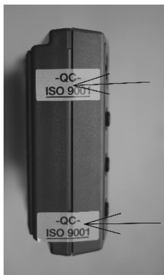
Рисунок 2 - Место пломбирования от несанкционированного доступа
