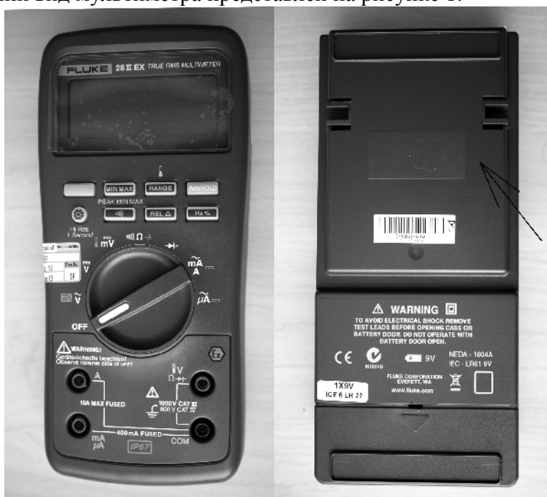
Рисунок 1 - Внешний вид мультиметра, стрелкой показано место нанесения знака утверждения типа.
