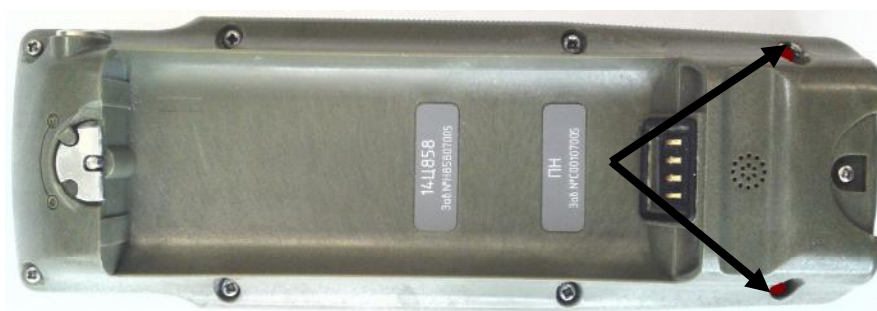
Рисунок 3 – Места пломбировки от несанкционированного доступа
