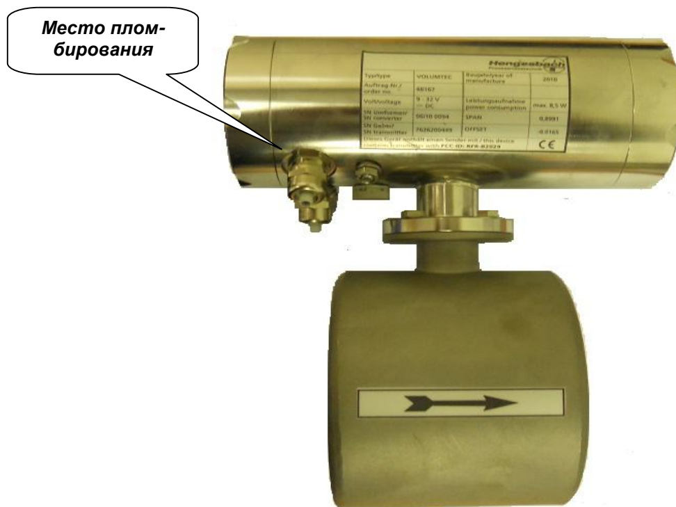
Рисунок 1 – Расходомер жидкости магнитно-индуктивный VOLUMTEC
