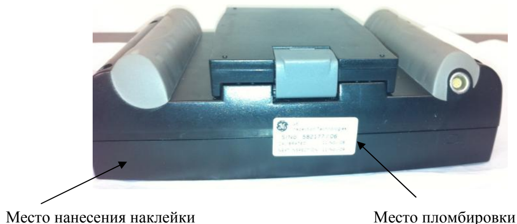
Рисунок 3 – Место пломбировки корпуса дефектоскопа Phasesc 3 и Phasesc 3d и место нанесения наклейки
