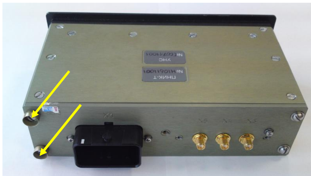
Рисунок 3 – Место размещения защитных пломб
