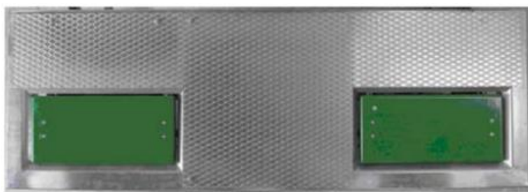
Стенд диагностирования подвески EUSAMA 3000
