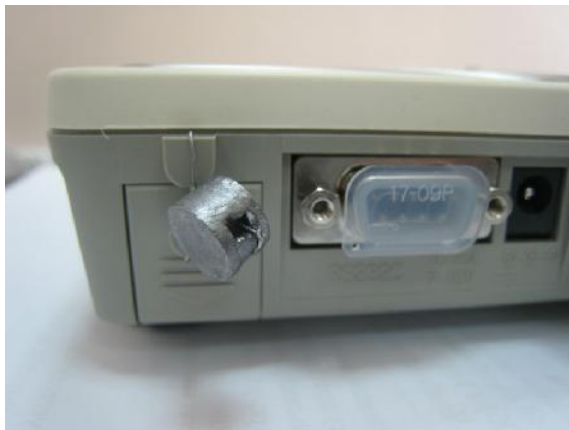
Рисунок 2 – Схема пломбировки от несанкционированного доступа
