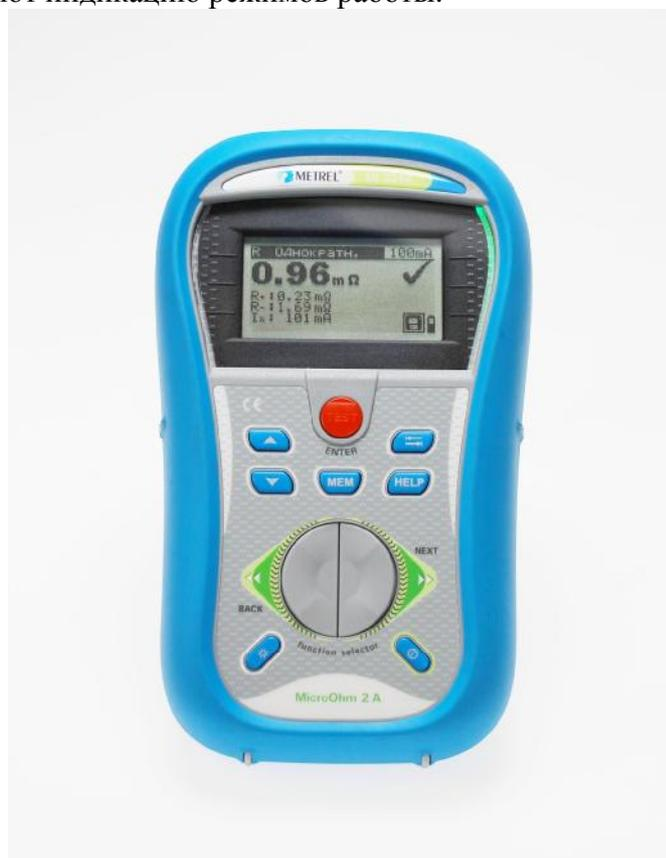
Для привязки результатов измерений ко времени их выполнения в приборах имеются системные часы и календарь. Для связи с внешним персональным компьютером приборы оснащены интерфейсами RS-232 и USB.
