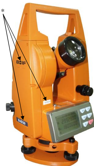
Примечание * - обозначения мест для размещения наклеек Рисунок 1 - Внешний вид теодолита и схема размещения наклеек
