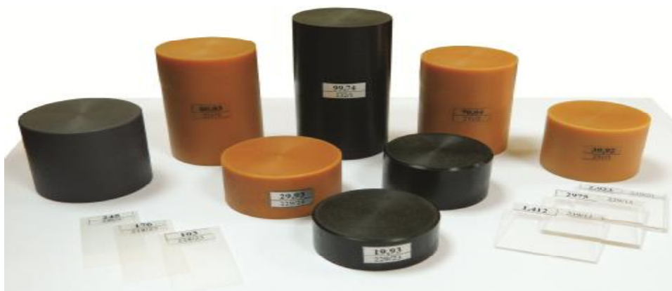
Рисунок 1 – Меры толщины покрытий МТ
