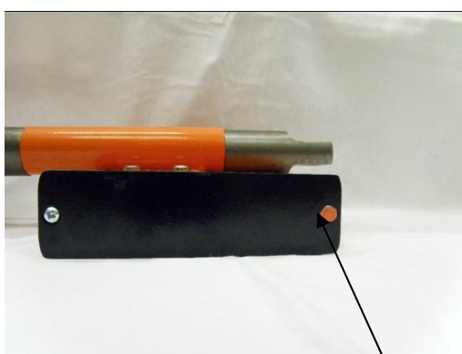
Место для нанесения знака поверки для варианта исполнения Л
