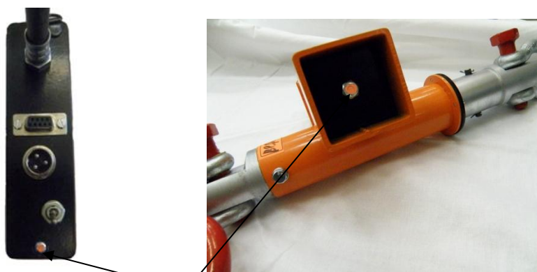
Места для нанесения знаков поверки для варианта исполнения Д
