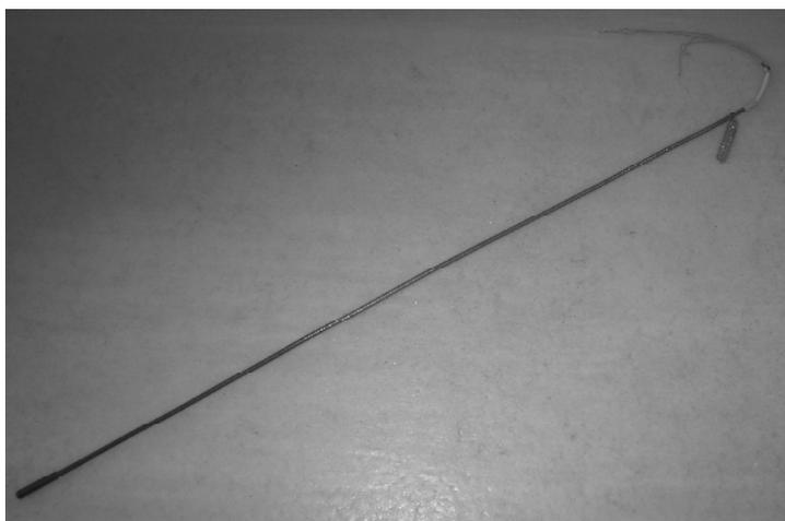
Рис.1 Термопреобразователи сопротивления ТСП-1790.
