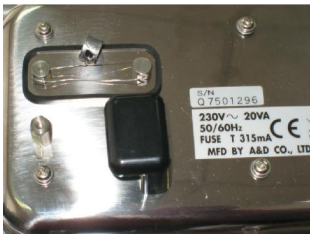
Рисунок 2 – Схема пломбировки весов
