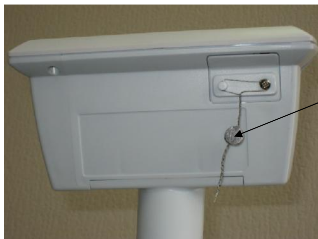
Рисунок 2 - Схема пломбировки весов.
